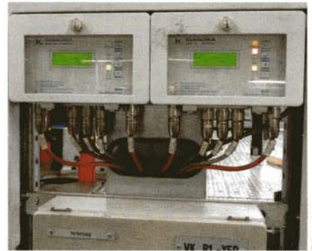
Klaschka hat seine Doppelblechkontrolle durch eine Blechdickenfühler-Weiche ergänzt, womit die Auswahl eines Blechdickenfühlers aus maximal vier vorhandenen Fühlern ermöglicht wird.
